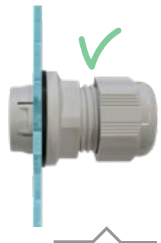
L'innesto è fornito di una molla che facilita l'installazione dei pressacavi e permette di adattare il pressacavo allo spessore del telaio da 0,5 a 4 mm.
